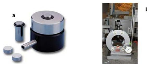
**Figure 5.** Aldrich® macro-micro KBr pellet die (a), BECKMAN 25 ton ring press 00-25(b)
