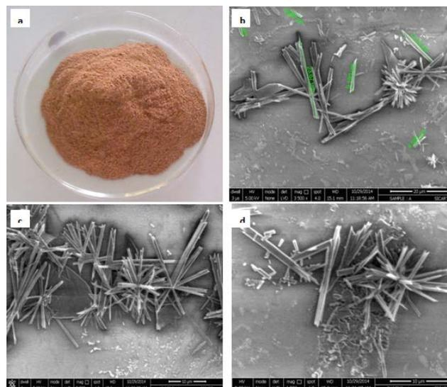
**Figure 1.** (a) *Moringa Oleifera* gum powder, (b) (c) (d) SEM images of bionanofibers
