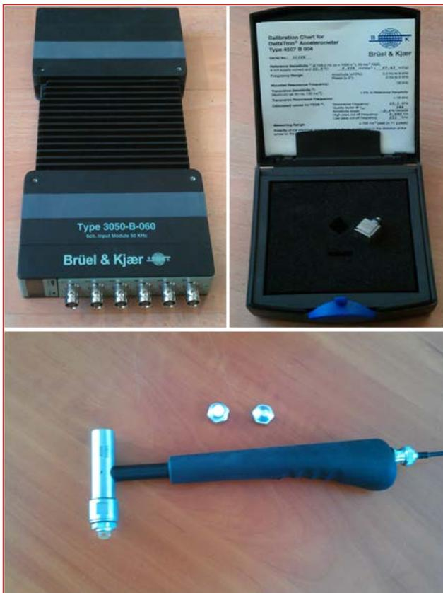
Figure 2.a) Modul Pulse b) Monoaxial accelerometer c) Modal hammer
